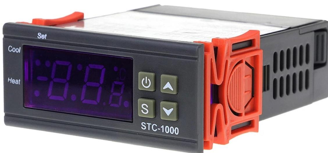
**Контроллер температуры STC-1000 220v** является готовым устройством с двумя реле: на охлаждение и обогрев. С его помощью можно выставить два температурных режима срабатывания. Одним из преимуществ термостата является простота подключения, наличие калибровки и программирование температуры срабатывания, получаемой с датчика. Термореле может применяться в водонагревателях, морозильных камерах, холодильниках, аквариумах, инкубаторах, брудерах, самогонных аппаратах, серверных шкафах и т.д.
