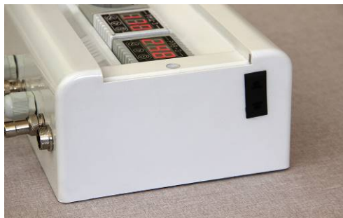
Фото 9. Розетка для подключения воды
