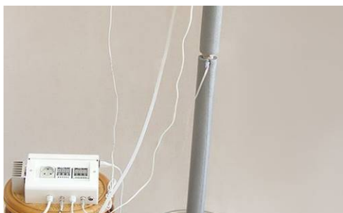
Фото 30 Термометр в средней части колонны
